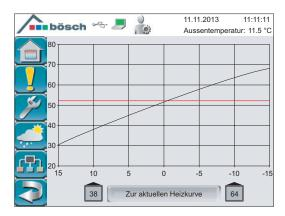
Ist Ihnen zu kalt oder zu warm? Die Touch-Bedieneinheit erlaubt über einfaches Verschieben, das kinderleichte Anpassen des Raumsollwertes und der Heizkreise.
